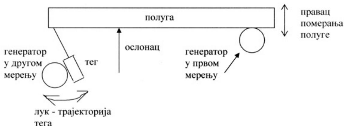
**Прво мерење:** генератор покреће полуга.
