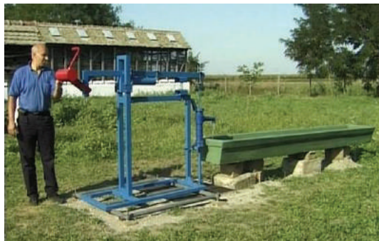
Ručna pumpa za vodu sa klatnom na terenu (okolina Novog Sada, avgust 2004.) http://youtu.be/hNpgl7o_1QI
