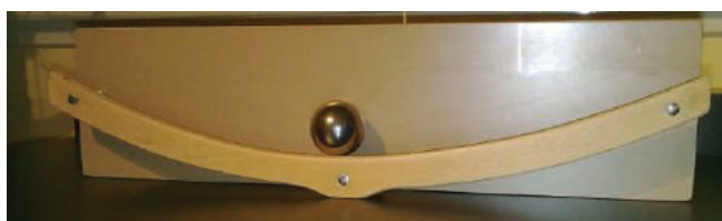
slika 3. replika detalja, naizmenično kotrljanje kuglice traje 22 sekunde
