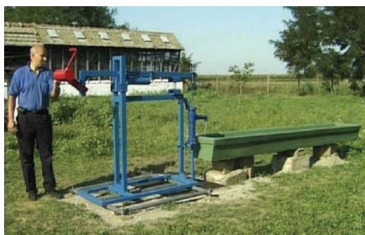
Slika 3. Ručna pumpa za vodu sa klatnom na terenu (okolina Novog Sada, avgust 2004.) http://youtu.be/hNpgl7o_1QI
