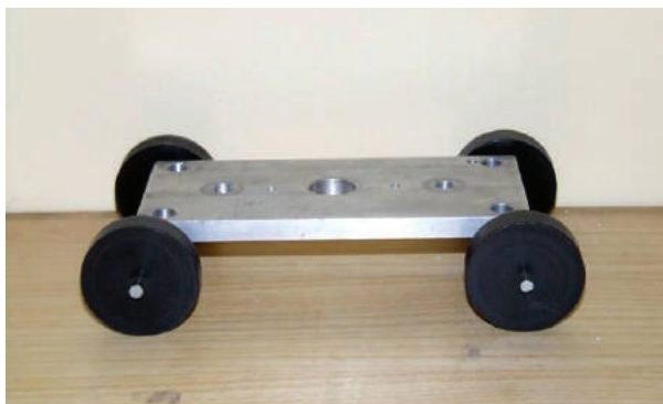
Slika 3. Pored toga vršene su probe i sa kolicima, koja su se usled inercije održala u kretanju 6-9 sek.
