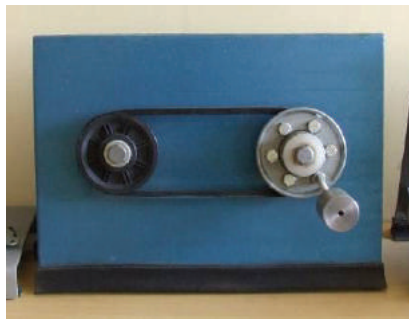
Slika 9. Prenosnici reduktori - rotacija traje od 1 - 2,5 sek.
