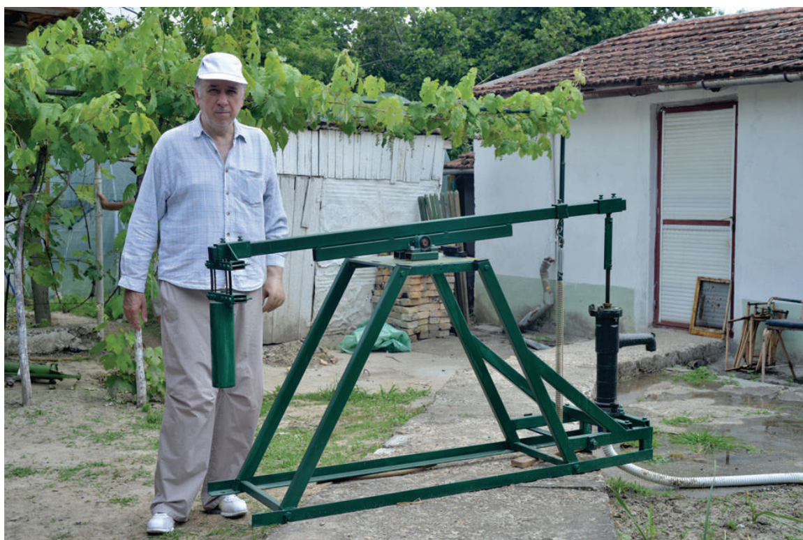
Slika 6. Pumpa za vodu sa elastičnim klatnom od 17 kg i 4 elastične trake.
